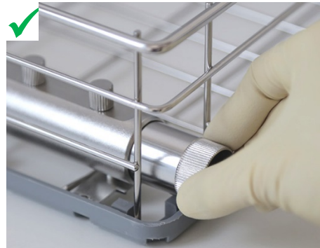
Abb. 3: Cleanfinity Filter einsetzen
