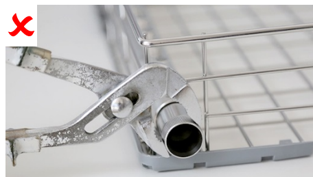
Abb. 5: Zentralfilter ohne Werkzeug entnehmen
