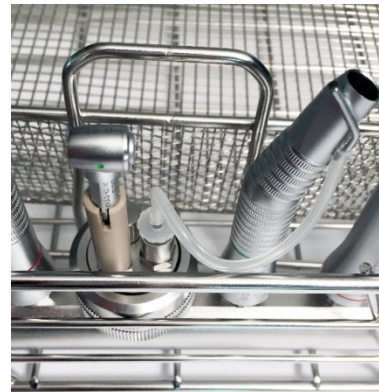
Abb. 34: Adapter wird mit dem zu spülenden Übertragungsinstrument verbunden
